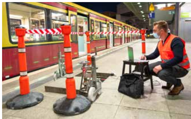
Christopher Schubert, DB-Projektleiter, beim Testen der Software der leuchtenden Bahnsteigkante am Gleis 1, Bahnhof Berlin Südkreuz.
