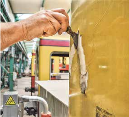
Vor dem Lackieren: Spachteln und Schleifen und Grundieren
